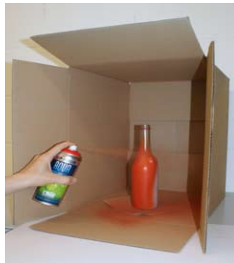
Die Verbreitung von Sprühnebel lässt sich geschickt eingrenzen, indem man das zu lackierende Objekt in einen großen Umkarton stellt.
