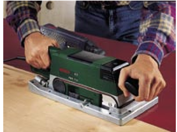
Ein Schleifrahmen ermöglicht exaktes Planschleifen großer Oberflächen.
