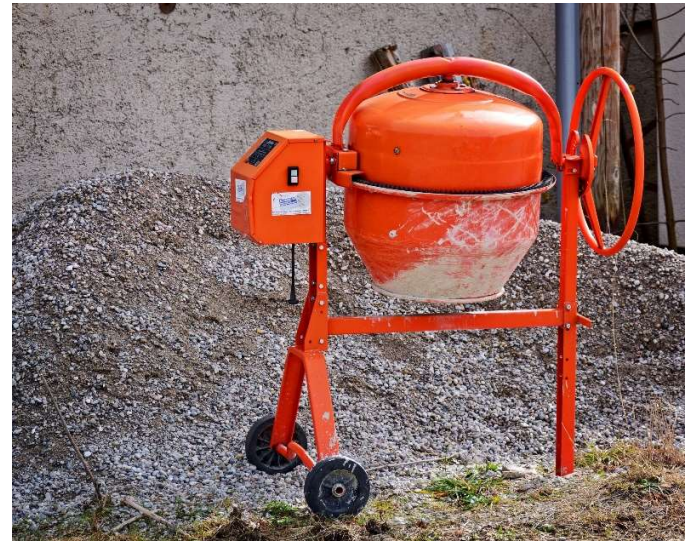
Zum Mischen eignen sich am besten elektrische Betonmischer.
